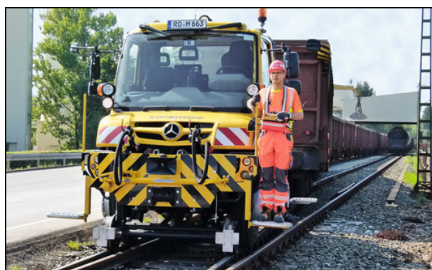
Rys. 5 – Samochód Mercedes-Benz Unimog U423 do zastosowań kolejowych [10]
