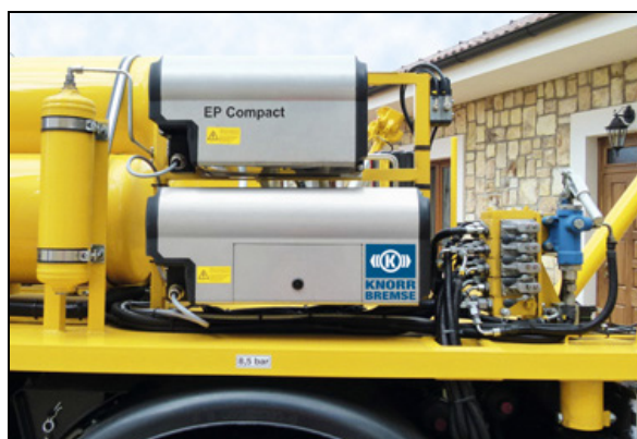
Rys. 6 – Elementy składowe układów zastosowanych w samochodzie U423: a) pneumatycznego, b) hydraulicznego [10]
