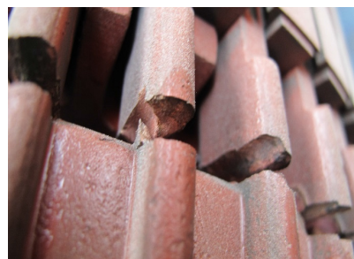
Rys. 4. Przełom uszkodzonych prętów wirnika silnika trakcyjnego [1]
