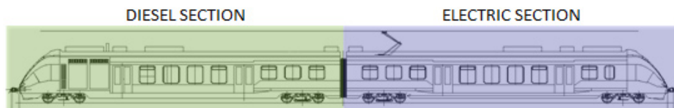
Rys. 1. Pojazd szynowy typu 227M składający się z członów: spalinowego oraz elektrycznego. [Materiały własne]
