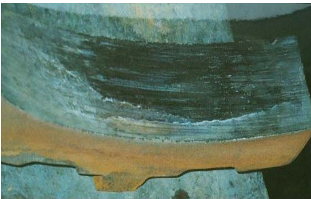
Rys.2 Powierzchnia wstawki żeliwnej po próbach hamowania nagłego
