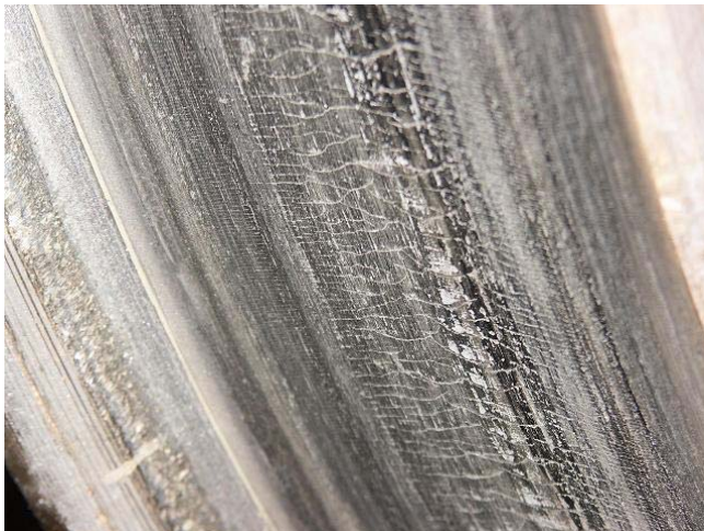
Rys.7 Siatka termicznych pęknięć na powierzchni koła
