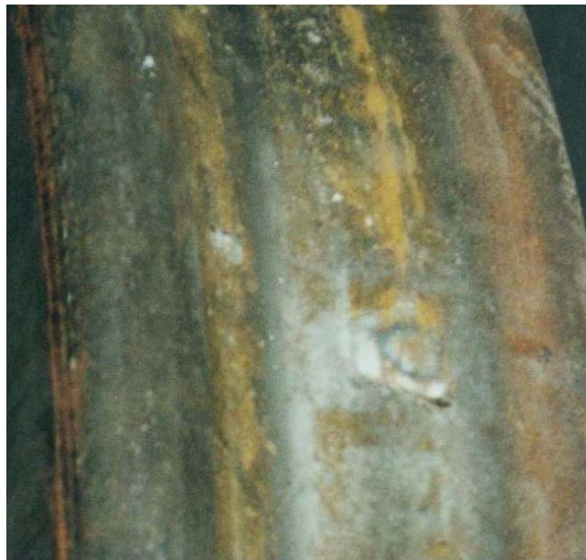
Rys.9 Przegrzanie miejscowe na powierzchni tocznej koła w wyniku poślizgu
