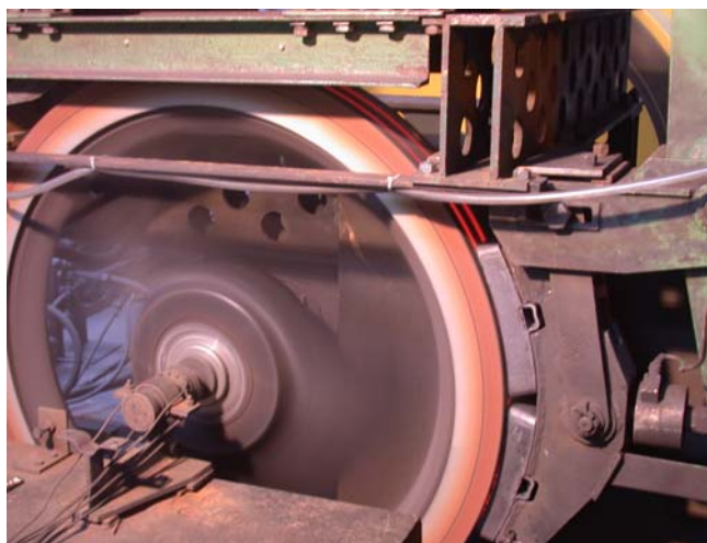
Rys.4 Hamowanie nagle wstawkami ze spieków na stanowisku bezwładnościowym; badania dla modernizowanej lokomotywy EP07 ze wstawkami Carbone Lorraine 4x250 UIC250, materiał wstawk C17
