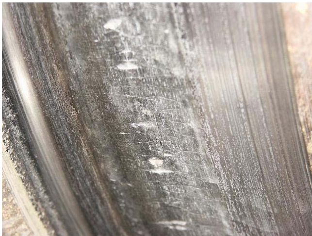
Rys.8 Wykruszenia materiału powierzchni tocznej koła tzw. pitting
