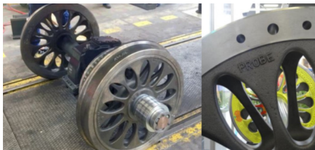
Rys. 4 Projekt kół szprychowych „ADI Spoke Wheel” [9] Fig. 4 Design of spoked wheels „ADI Spoke Wheel” [9]
