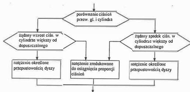
Rys. 13. Uproszczony algorytm pracy zaworu rozrządczego w procesie hamowania.
