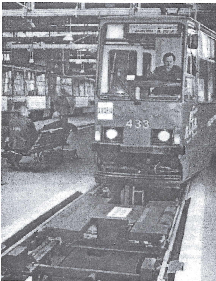
Rys.4. Tramwaj podczas pomiaru na stanowisku diagnostycznym typu PZK
