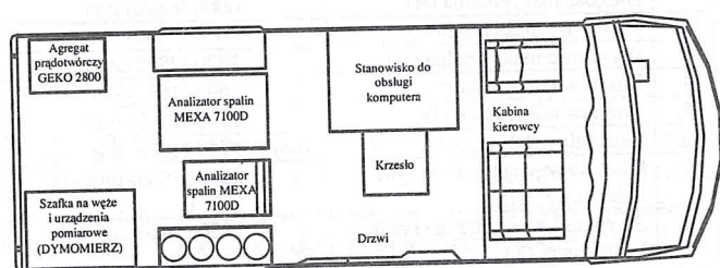
Rys. 6. Schemat rozmieszczenia urządzeń w pojeździe
