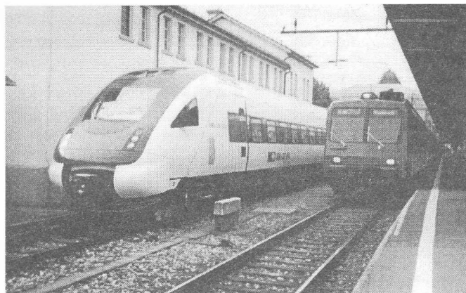
Rys.14 Szwajcarski zespół trakcyjny z wychylnym nadwoziem SBB-Neigezug (fot. Piotr Wolko).
