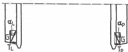
Rys.6. Rozkład nacisków kół o profilu stożkowym na szynie
